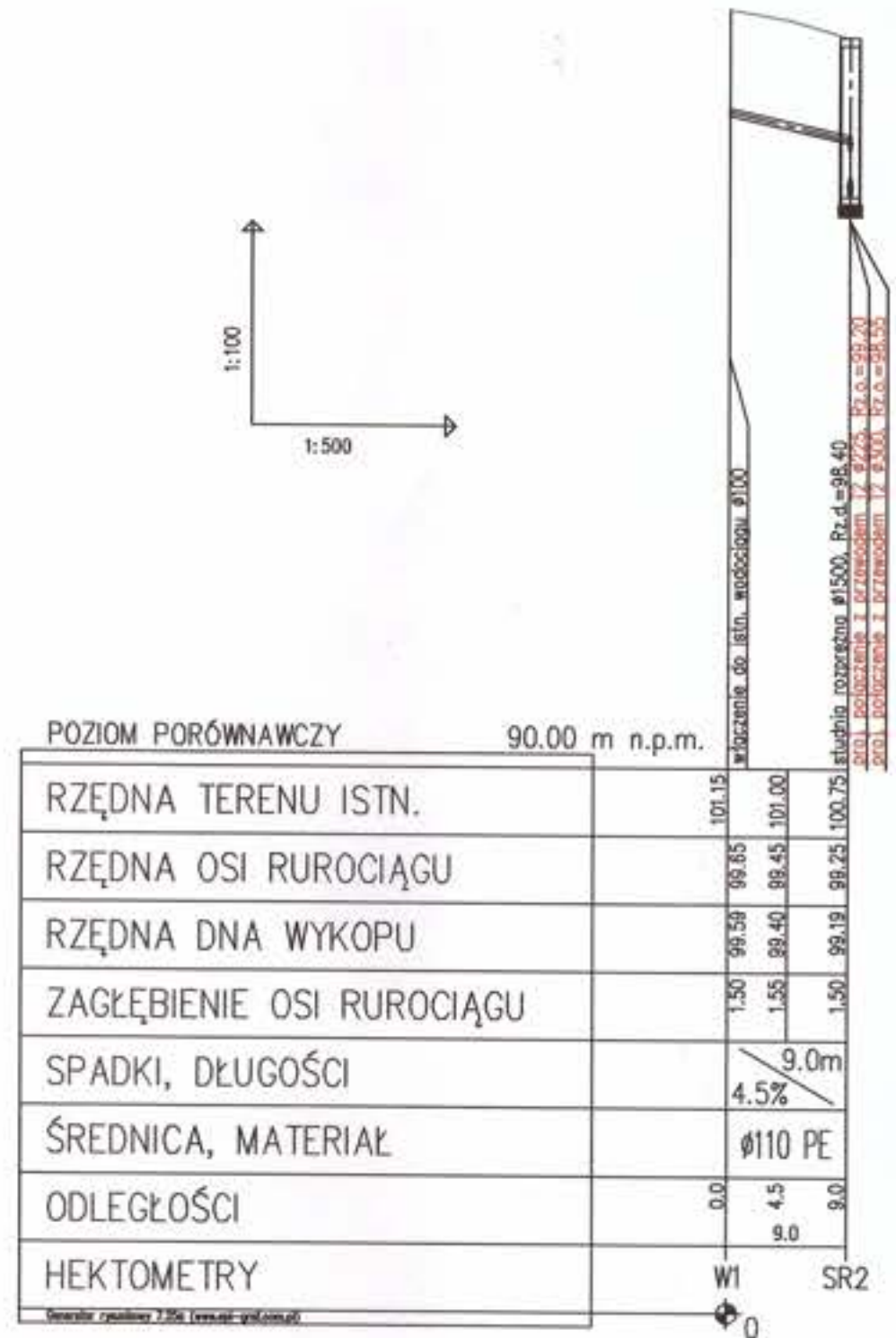
Profil podłużny - wodociągu zasilającego
