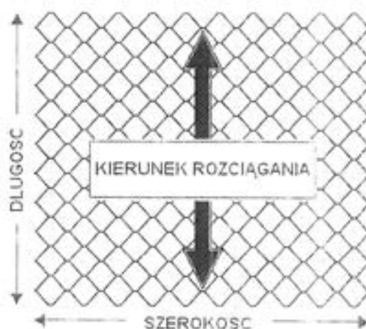
Rysunek 4 - Sekcja geosiatki komórkowej GEOMAXX ® - określanie kształtu i wymiarów
