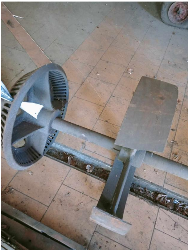
Widoczne uszkodzenie koła pasowego (brak tego elementu)
